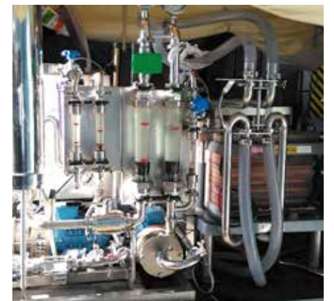
Protótipo de electrodiálise de vinhos em processo de patenteamento
