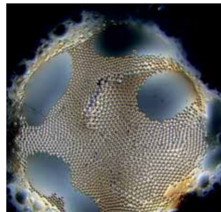
Defeitos topológicos na superfície de uma gota de Cristal Líquido observada ao microscópio entre polarizadores cruzados
