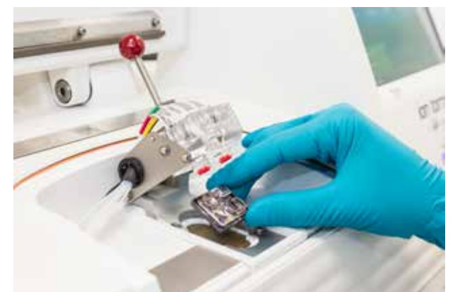
Chip de sequenciação de Nova Geração de ADN (do inglês, Next Generation Sequencing)
