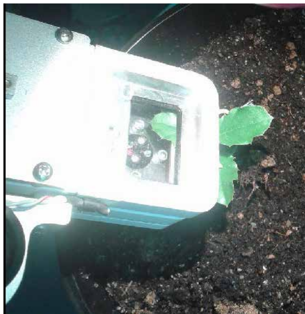
Medição da taxa de fotossíntese de um pequeno sobreiro com um IRGA (InfraRed Gas Analyzer). Parte-se das medidas clássicas, mais complexas e fundamentais, para depois desenhar medições mais simples a incorporar na futura rede de sensores
