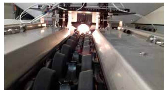
Sistema ótico para determinação automatizada de defeitos internos em calibradores de fruta. Em primeiro plano vê-se a linha de calibração de uma máquina da Calibrafruta e ao fundo uma pêra iluminada. A luz transmitida é analisada por um espectrómetro e o espectro resultante classificado através de um algoritmo de estatística multivariada.
