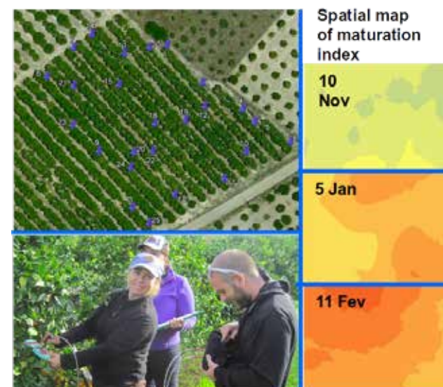
No projeto "Optimal Harvest Date" utiliza-se um espectrómetro portátil nos pomares (atualmente de laranjas e kiwis) de forma a adquirir dados espectrais com o objetivo de construir modelos de previsão da data ótima de colheita dos frutos.
